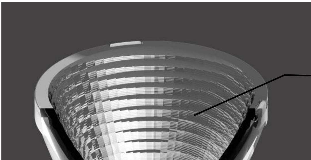
在合理分配中间光线与反射面光线的基础上，加上反射面的鳞面微分结构，使得光斑变得比较柔合，同时可对反射面光线进行精准控制，避免出现分层。暗环等现象。
