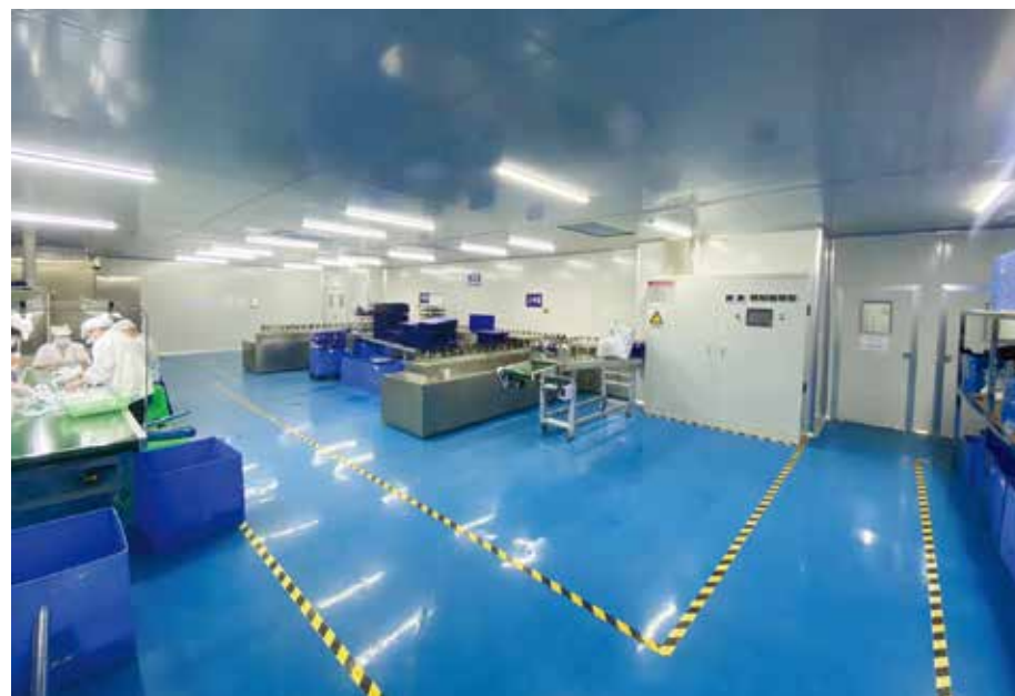
自建PC真空镀铝车间，一条喷涂生产线，两台真空电镀机，100000级净化车间
